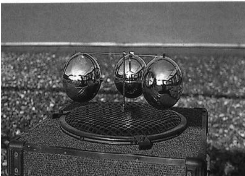
Bild 4: Das drehbar über einer Lautsprecherbox angebrachte Weihnachtsgugelrad, wird von unten beschallt und mit akustischer Energie versorgt.
